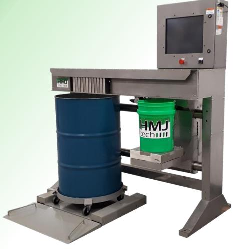
La opción multiescala brinda la mejor combinación de capacidad Y precisión. La función de receta multiescala de HMJ tech le permitirá dosificar el ingrediente principal más rápidamente, pero igual conseguirá una precisión absoluta en los componentes críticos.
